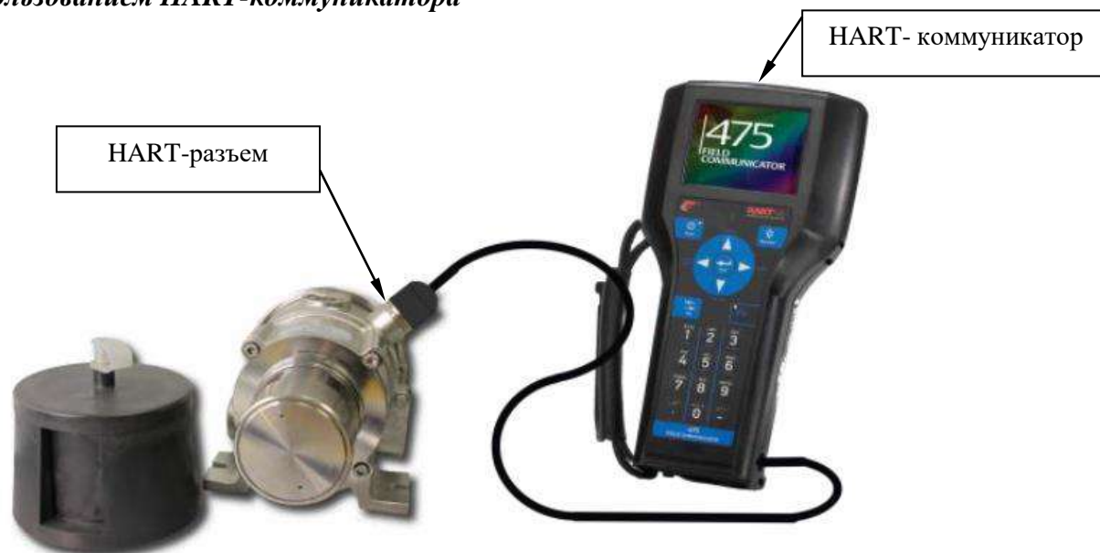
Рисунок 13 – Газоанализатор СГОЭС-М11, подключенный к HART-коммуникатору
